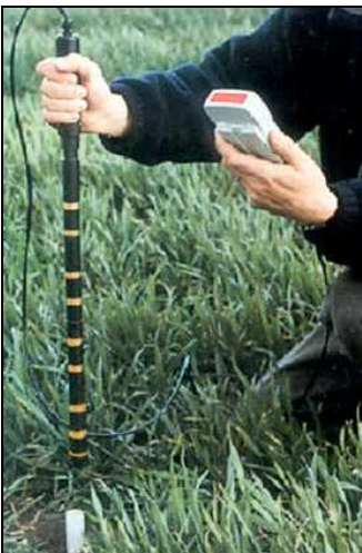
Fig. 8. Sonda de capacitância. Fonte: Delta T.
