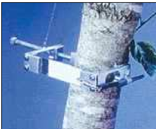
Fig. 11. Dendrômetro para avaliar a variação do diâmetro do tronco. Fonte: Dynamax.
